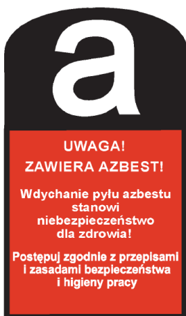
Rysunek 1. Wzór oznakowania wyrobów, odpadów i opakowań zawierających azbest lub wyrobów zawierających azbest, a także miejsc ich występowania [12]
